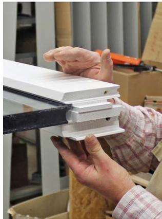
*Eckverbindung Konter/verschraubt wird mit zwei Schrauben hergestellt*
