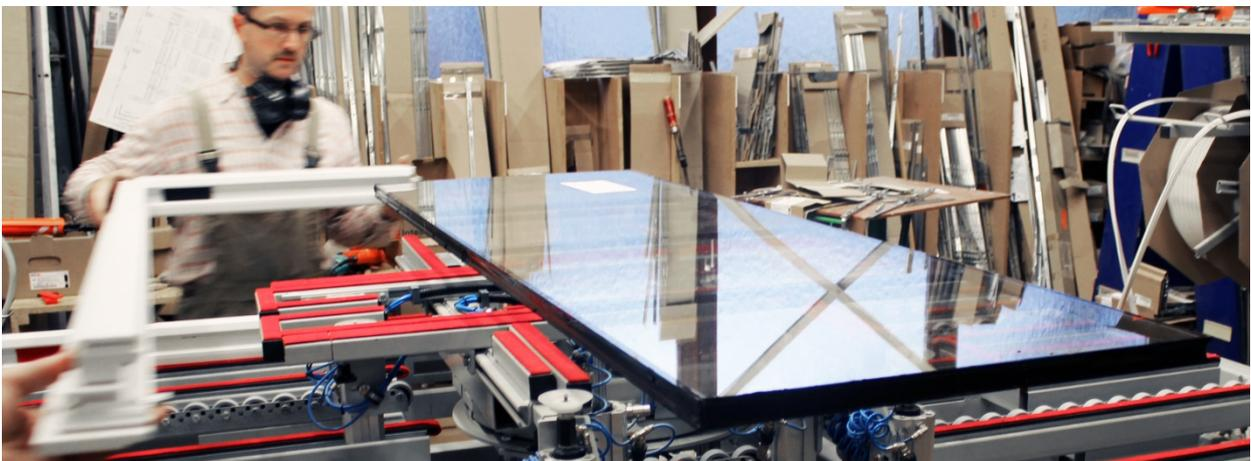
*Bild oben: Vormontierte Rahmenecken werden vorbereitet*
